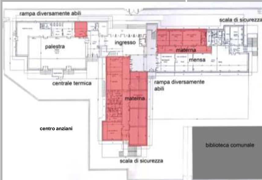
rilievo dell'ufficio tecnico del VI Municipio del Comune di Roma aggiornato con il sopralluogo – planimetria (in rosso le parti utilizzate dalla scuola materna, gli ambienti restanti sono appartenenti alla scuola elementare)
