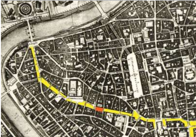
Planimetria di base del Piano Regolatore del 1873 elaborata sulla Pianta topografica di Roma edita nel 1866 e redatta sulla base dei rilievi eseguiti per il Catasto Urbano, a colori è indicato il progetto delle demolizioni per la realizzazione di Corso Vittorio Emanuele.
