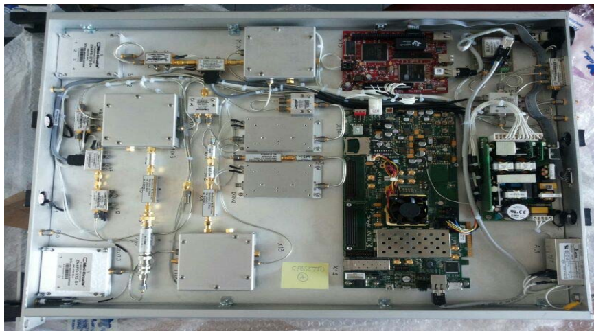
Fig. 1 Piattaforma per l'emulazione del canale di comunicazione e del transponder satellitare
