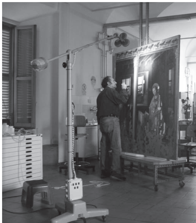
Fig. 7. Prototipo di un illuminatore LED utilizzato per il restauro dell'Annunciazione di Antonello da Messina, all'interno dei laboratori di restauro ICR al San Michele (2007).
