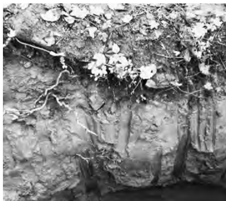
Fig. 7. Appena al di sotto del suolo agricolo nelle campagne intorno a Cremona le lenti argillose si presentano compatte almeno fino ad una profondità di 1,5-2 metri.
