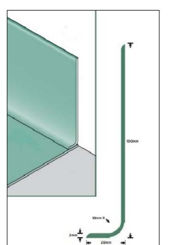
DETTAGLIO RACCORDO IN PVC TRA PAVIMENTO IN PVC E PARETI TINTEGGIATE
