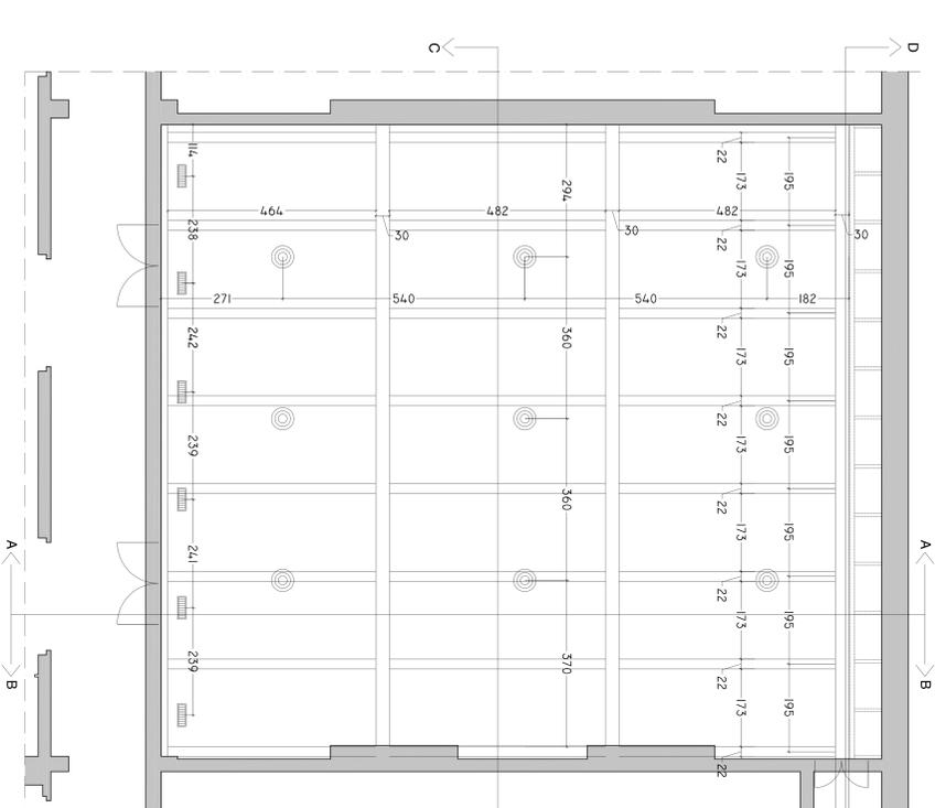
PIANTA CON TESSITURA TRAVI E ANEMOSTATI
