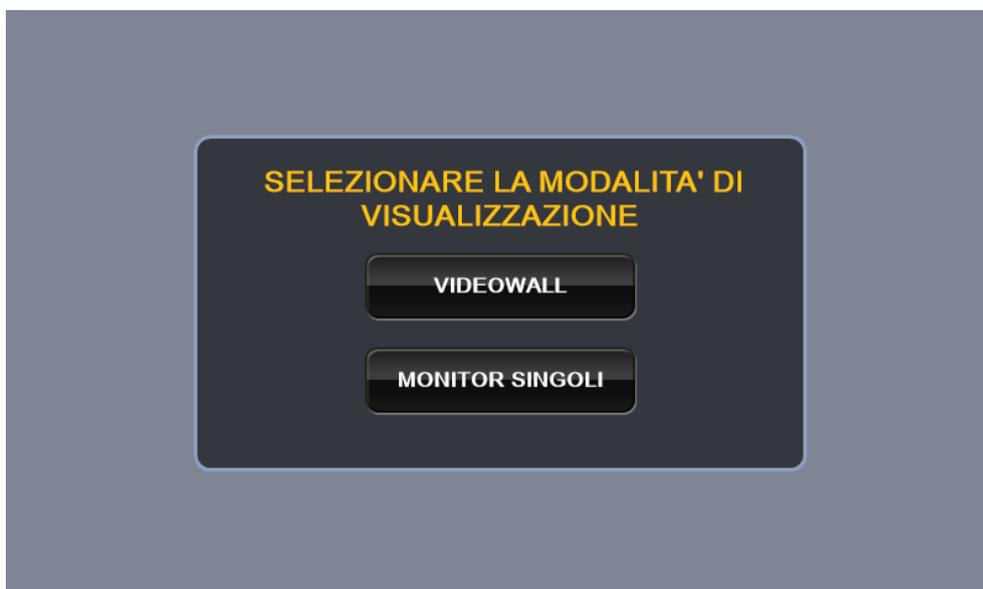
*La prima schermata dopo l'avvio del sistema permette di selezionare la modalità di lavoro del videowall. Le modalità disponibili sono: modalità VIDEOWALL (immagine unica) oppure modalità MONITOR SINGOLI (4 immagini diverse o uguali su ogni singolo monitor). Scegliendo la modalità VIDEOWALL si passa alla schermata di gestione dello stesso, altrimenti scegliendo la modalità MONITOR SINGOLI si passa alla schermata di selezione dei singoli schermi.*
