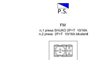
*N.B. DA INSTALLARE INCASSATE A PARETE (H 30cm da pavim. finito)*
