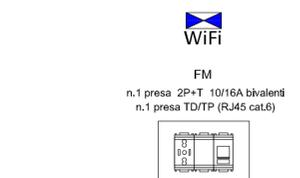
*N.B. DA INSTALLARE INCASSATE A PARETE (H 240cm da pavim. finito) DOTARE LA CASSETTA DI SETTO SEPARATORE*
