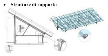
Le strutture di supporto sono di tipologie differenti : 1) Strutture in alluminio per tetti piani costituita da staffe, fissate sulla copertura, che sostengono dei profili scanalati in alluminio. Su questi profili devono essere inseriti dei morsetti che bloccano i moduli fotovoltaici. lunghezza dei profili deve essere leggermente superiore alla larghezza complessiva dei moduli in modo da poter agevolmente posizionare i morsetti.
