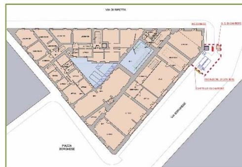
Per quanto riguarda i lavori in copertura l'ingresso delle maestranze per le lavorazioni impiantistiche per il posizionamento e collegamento della UTA avverrà dalla scala lato uffici, mentre per le lavorazioni edili
