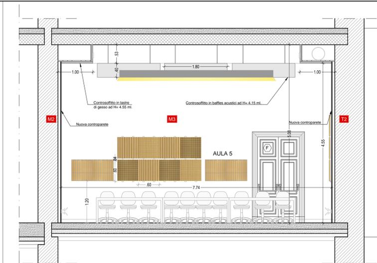
PROSPETTO-SEZIONE B-B' - SCALA 1:50
