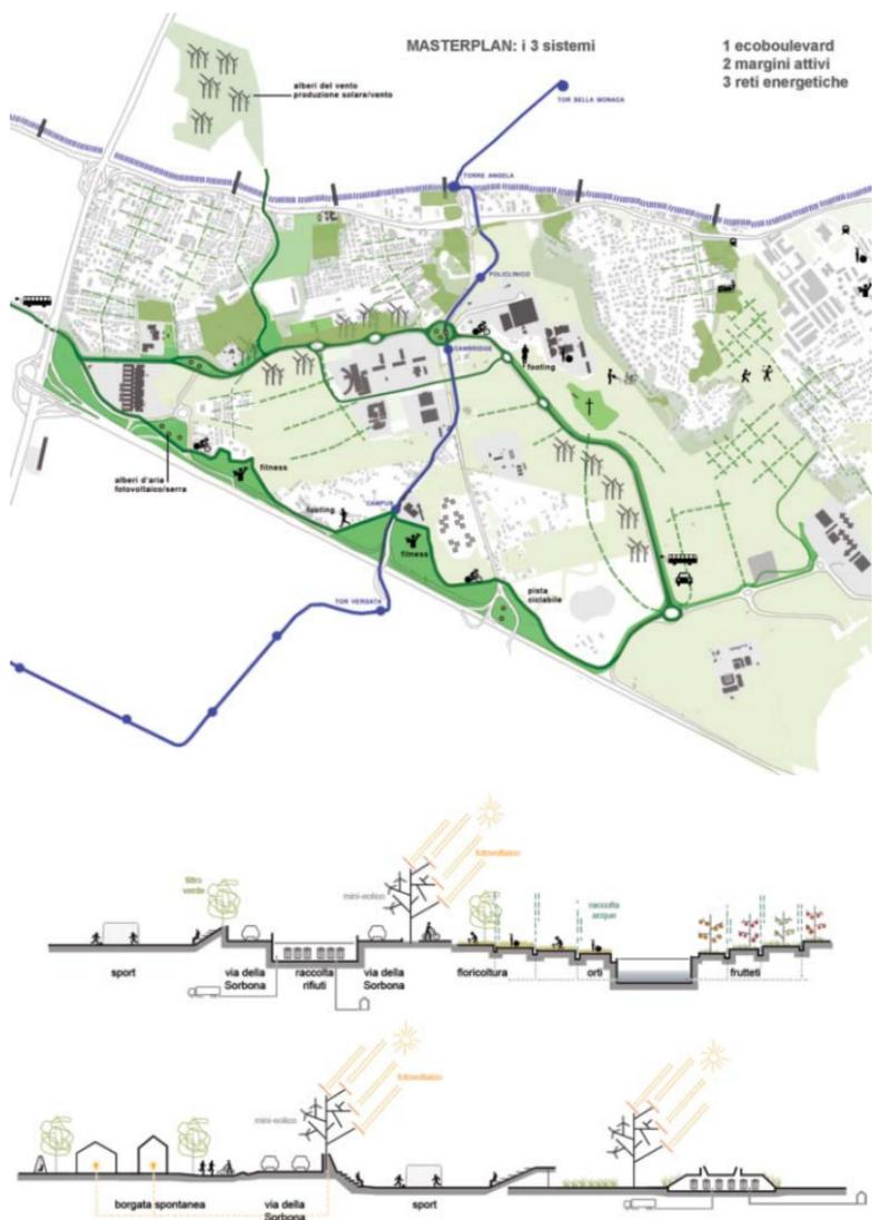
**Periferia est di Roma. Il masterplan con i tre sistemi e sezioni schematiche della trasformazione di via della Sorbona in Ecoboulevard in grado di integrare differenti funzioni.**
