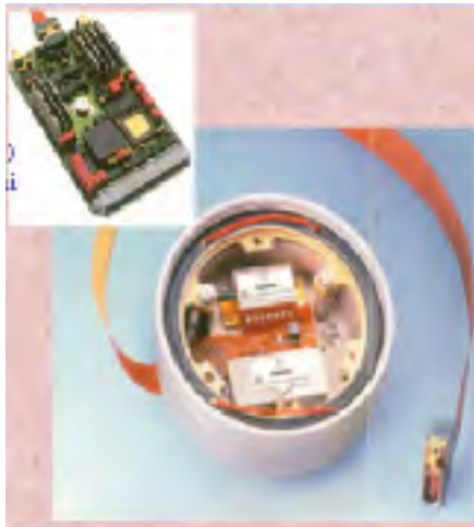
Giroscopio in fibra ottica
