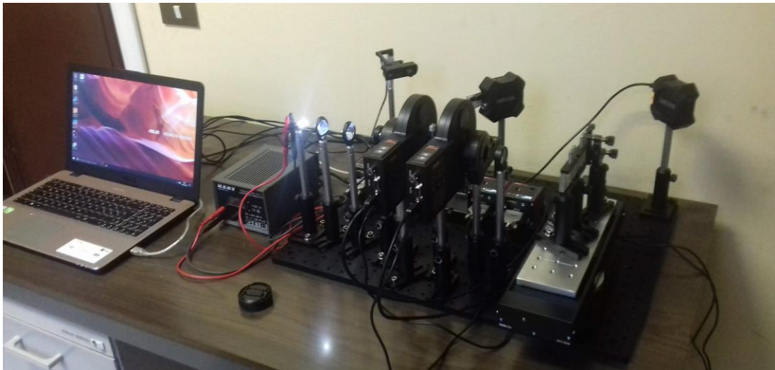
Figura 11: apparato sperimentale didattico gestito da computer con analizzatori di spettro con prisma e reticoli di diffrazione e diversi campioni di misura.
