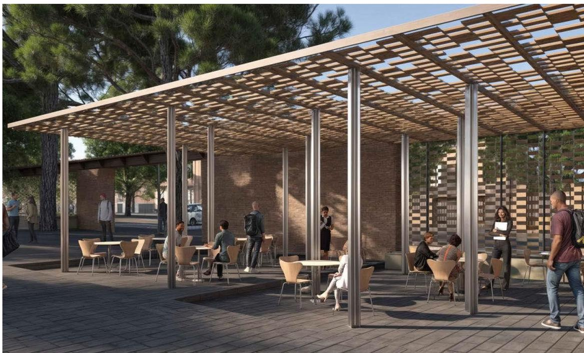
*Infine è opportuno segnalare che per garantire la qualità ambientale e spaziale dell'area esterna della caffetteria è stata inserita una pensilina quadrata per l'ombreggiamento costituita da una sottostruttura in acciaio sostenuta da pilastri con profilo a croce. La sottostruttura sostiene nuovamente una maglia metallica con laterizi appesi con andamento randomico in modo da proiettare la propria ombra a terra creando giochi di luce dinamici.*
