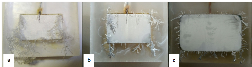
Figura 100 Sviluppo di dendriti a: a) 300 \text{ A/m}^2 , b) 200 \text{ A/m}^2 , c) 100 \text{ A/m}^2
