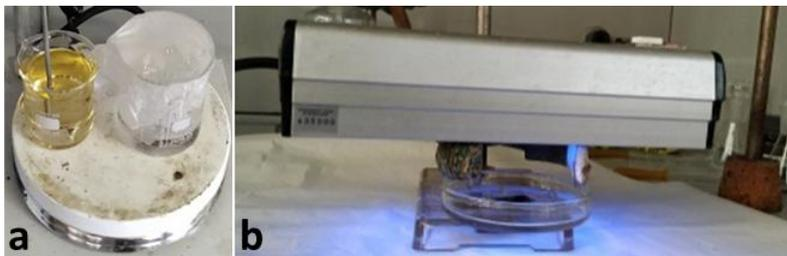
Figura 42. Sistema sperimentale utilizzato per la decorazione degli arrays di  $TiO_2$  con Ag: (a) immersione dei campioni nella soluzione di  $AgNO_3$ , (b) esposizione dei campioni sotto luce UV per la fotoriduzione.
