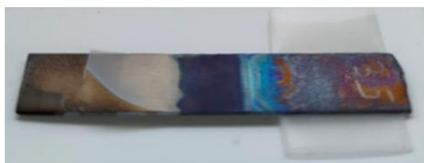
Figura 43. Array di nanotubi di  $TiO_2$  parzialmente distaccato dal substrato di Ti metallico a seguito del trattamento con HF.
